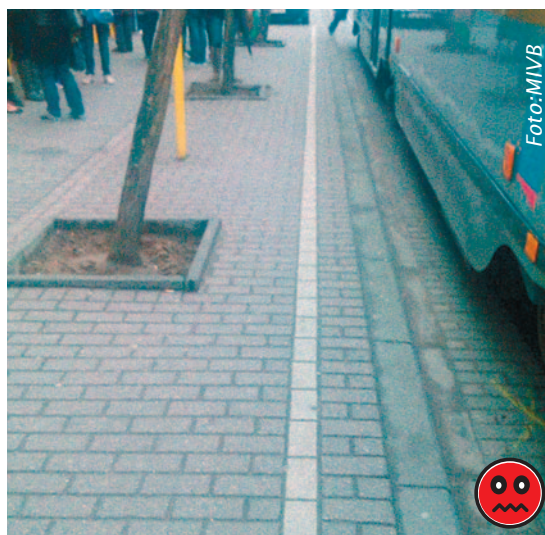
Opstaande kantstenen rond bomen vormen een obstakel voor voetgangers
