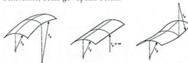
Fig. 3: Oppervlakte met positieve, negatieve of nul Gaussiaanse kromming [9].
