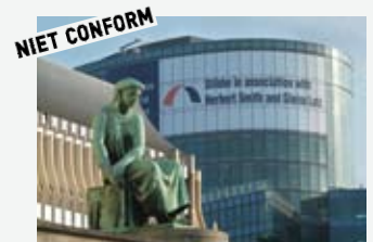
Niet-conforme reclame op vinyl, omdat de bovenste rand ervan zich meer dan 12 m boven de grond bevindt.
