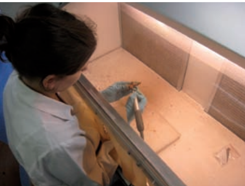
Behandeling van een metalen voorwerp door middel van microzandstraling in het LAB
