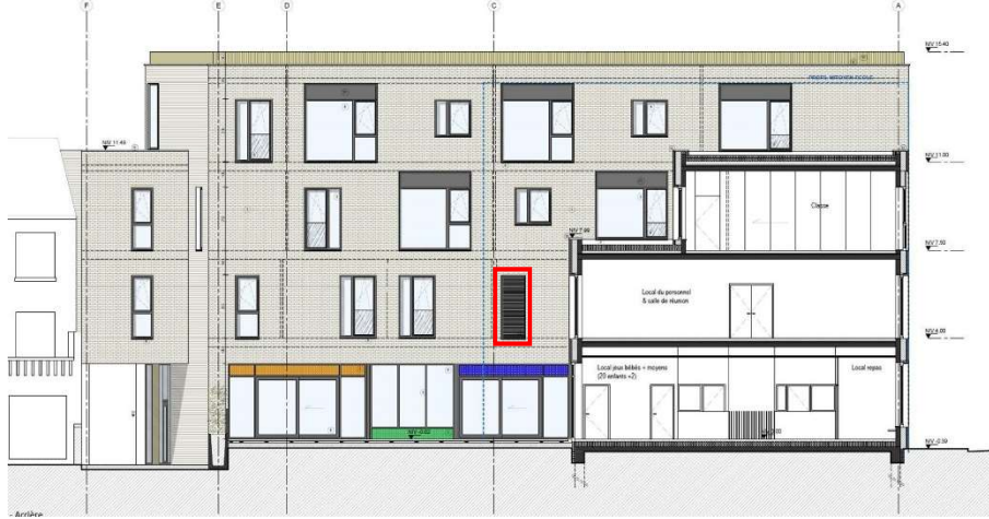
Figure 131 : Prise d'air en rouge sur la façade orientée ouest du projet vers l'intérieur d'îlot (R 2 D 2 , 2017)
