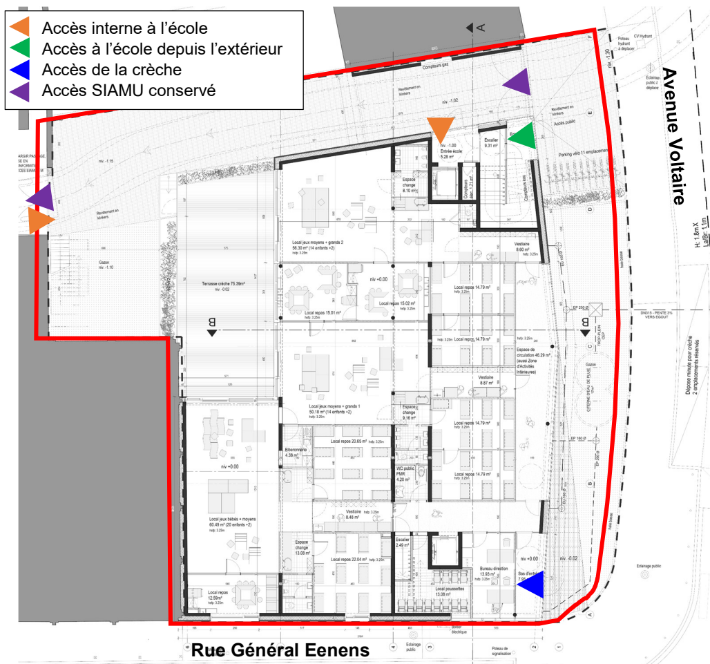
Figure 11 : Localisation des accès suivant le type d'utilisateur (ARIES sur fond de plan R2D2, 2017)
