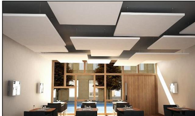
**Figure 3 : Exemple de panneaux absorbants suspendus**
