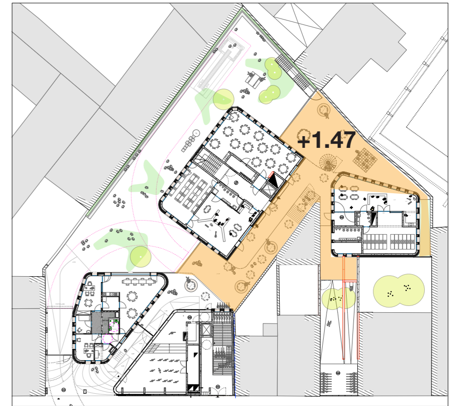
Rez-de-chaussée surélevé pour la maternelle avec réfectoire, salles de classe, classes d'accueil, rangements extérieurs et sanitaires
