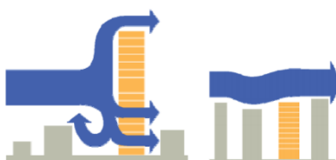
Figure 3: Effet de la présence d'une tour sur le vent en milieu urbain (Source: UCL/CLI (Juin 2009). BXXL – Objectivation des avantages et inconvénients des immeubles élevés à Bruxelles)
